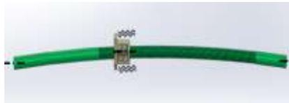
門型マシニングセンタなど、大径・長尺ボールねじを使用する場合、ねじ軸とナットハウジングの芯ずれが起こりやすくなります。長尺ゆえに芯がとりづらく、重量ゆえのたわみが発生するためです。また、長尺ボールねじにおいて、高速動作を行うと、高速化による縄跳び現象が発生し芯ずれが発生しやすくなります。
