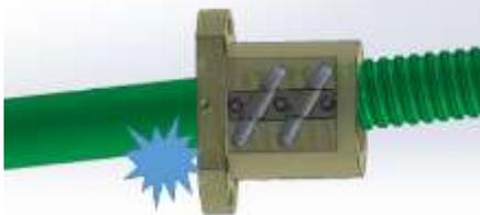
ボールねじにおいて、不完全ねじ部にナットが乗り上げてしまうことがあります。ねじ軸及びナットの転動面に打痕や圧痕が発生したり、最悪の場合、ボールねじが損傷することもあります。ナットの乗り上げは、高速動作の場合起こりやすく、ダメージも大きくなってしまいます。組付け時のリミット設定時に乗りあげてしまう場合もあり注意が必要です。
